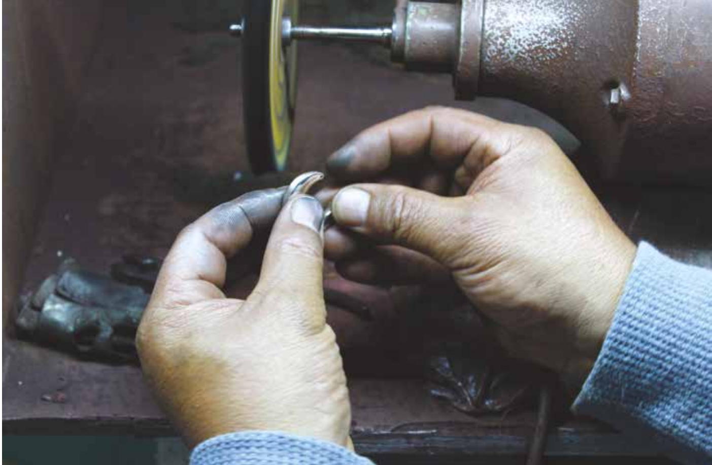
^ ARRIBA: Fig. 17 Cuando la arracada está soldada se liman todos los bordes. ABAJO: Fig. 18 Lijar y pulir son los pasos finales.
