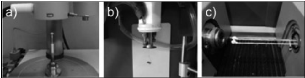
Figura 2. Clasificación de termobalanzas, a) superior, b) suspendida y c) horizontal (Auroux, 2013).
