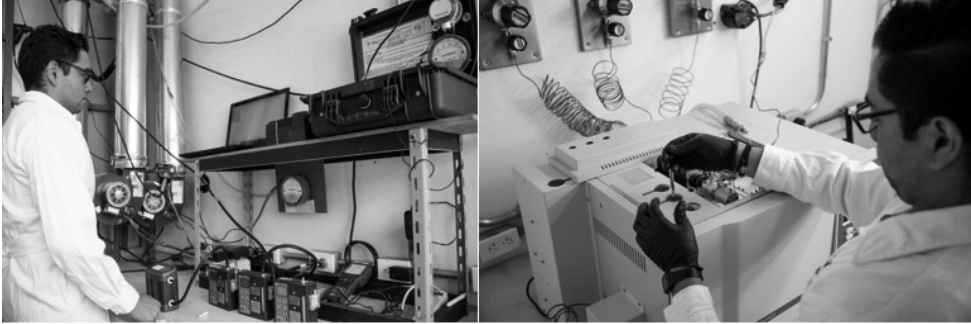
Ko' i yöho. Ya böja' japu paga medicón ra emision. A la derecha n' a kromatógrafo ya gas ne ra izquierda n' a imhi ya analizador ra flujo ya gas.
