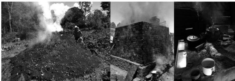
**Figura 4.** Emisiones en los diversos sectores, a la izquierda horno para producción de carbón vegetal, al centro horno para cocción de ladrillo, y a la izquierda un fuego abierto para cocinar.
