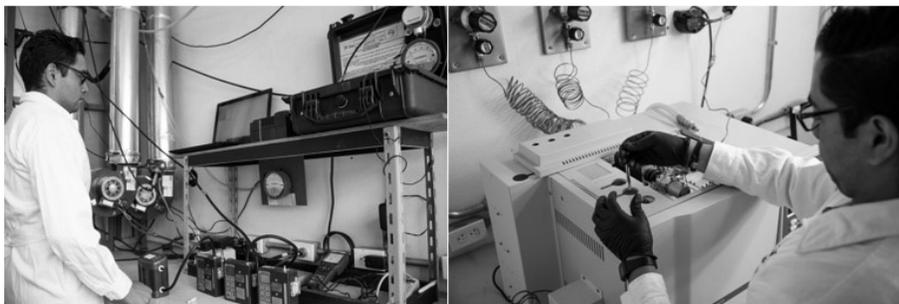
**Figura 2.** Equipos para medición de emisiones. A la derecha un cromatógrafo de gases y a la izquierda un conjunto de analizadores de flujo de gases
