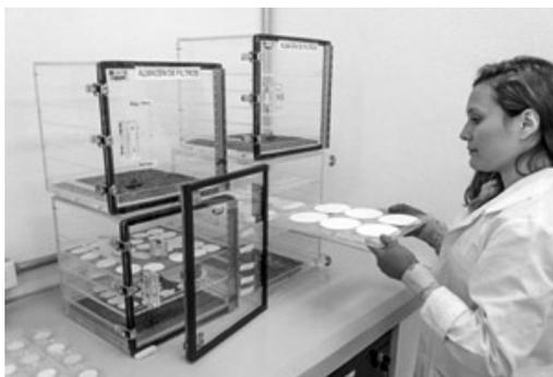
**Figura 3.** Manejo de filtros utilizados en la captura de material particulado
